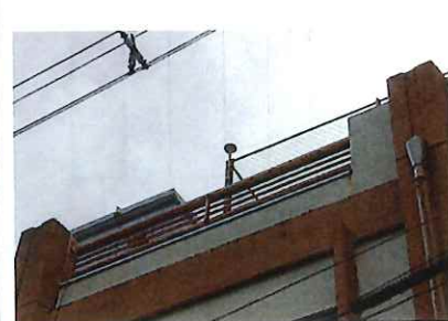
RTK 基地局の運用
